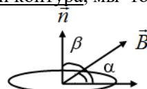
Поскольку в формулах угол  $\alpha$  – это угол между нормалью к контуру и вектором магнитной индукции, то, как следует из нашего рисунка, в мы должны подставлять угол  $\beta = 90^\circ - \alpha$ .
